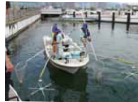
琵琶湖では従来の網などによる駆除に加え、2012年に「雷神」、2013年に「いかづち」と2台の電気ショッカーボートを導入した(写真提供 / 滋賀県水産課)
