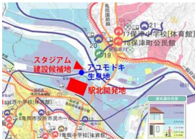
スタジアム建設地も駅北開発地も大雨が降ると3～5メートルも水没する場所に位置する（イラスト／亀岡市洪水ハザードマップを改変。竹門氏作成）
